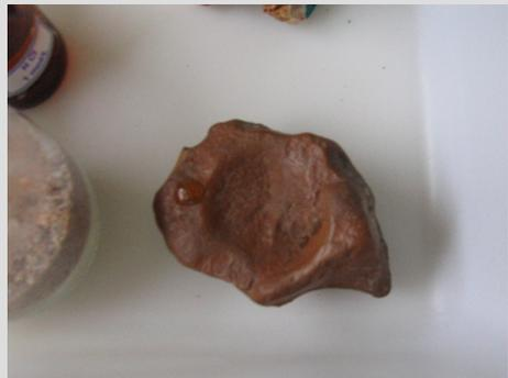
Par contre celle-ci n'en contient pas car il n'y a aucune réaction lors de l'expérience à l'acide. Il s'agit d'une roche amenée par la Loire : la meulière (s'apparente à du silex) .
